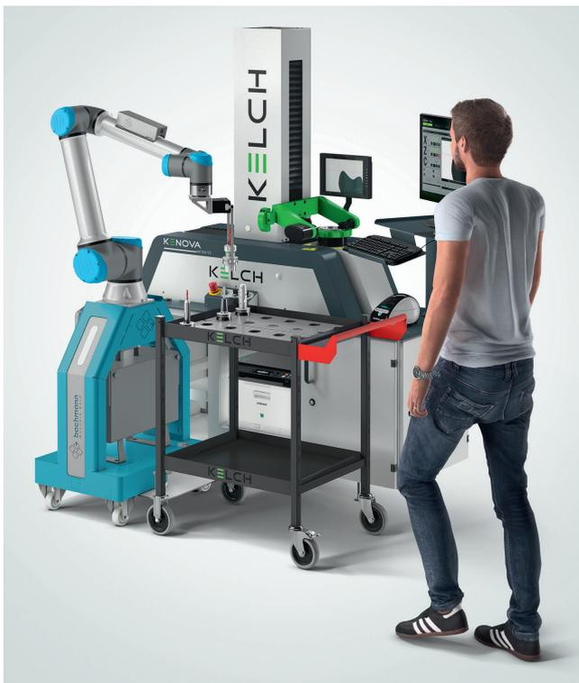
1 Automatisiertes Bestücken und Wechseln der Werkzeuge bei den Kelch-Einstellgeräten: hier mit einem Roboter UR10e inklusive Greifer auf der Bachmann Movable Base
