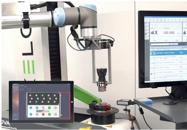
2 Werkzeugvoreinstellen und Roboter per Tablet steuern: Das gelingt mit der Kombination von Kenova set line V3 CNC und V956-S mit dem MyXPert ToolManager von MySolutions
